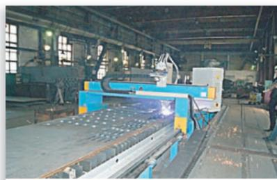
Новая установка для плазменной резки металла
